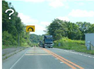
先のカーブ方向や程度がわから線形のため、大型の警戒標識を設置
