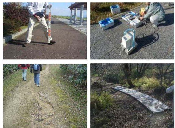
写真-3 フットパス路面に関する調査状況 (上:路面の硬さ及び滑り抵抗性に関する計測調査状況、 左下:火山灰路面の雨水による洗掘の状況、 右下:滞水対策の浮き橋の設置状況)
