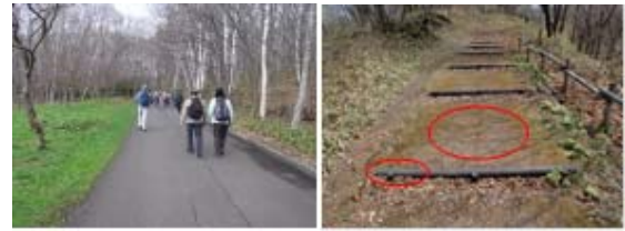
写真-7 道内フットパスコースの勾配 (左:歩きやすい勾配の例、右:急勾配箇所のすべり対策例)
