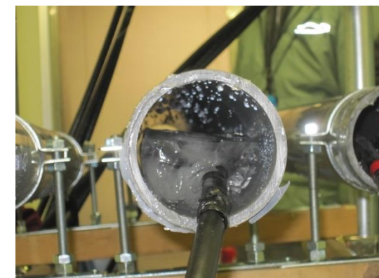
写真-9 凍結後の供試体内部 (上:満水 下:半水)
