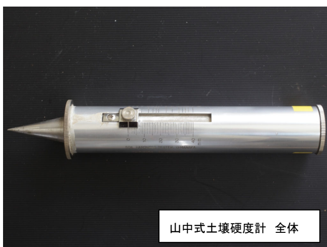
写真 3-3 山中式土壌硬度計
