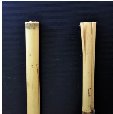
写真 節止めした晒竹（左）と節間で切断した晒竹（右）
