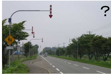
バスベイに矢羽根を設置した場合、除雪作業には有効だが視線誘導にはかえって分かりにくくなる。(特に夜間)
