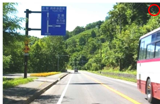
標識をセットバックすることにより、景観改善とともに、衝突の危険性も軽減された事例
