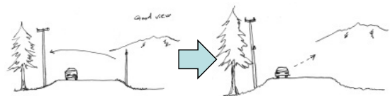
電柱の片寄せにより良好な景色が楽しめる
