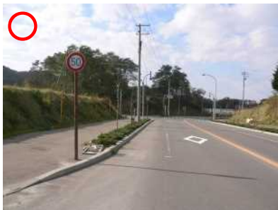
道路景観を考慮して規制標識を縮小した事例 (木製支柱を採用した事例)
