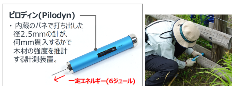
写真 A-1 ピロディン計測器の概要と計測例
