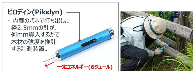
写真 4-3 ピロディン計測器の概要と計測例
