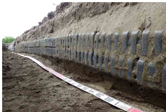
写真-3.40 砂充填性の確認（施工後1年）左：RR-VE管、右：角型FEP管
