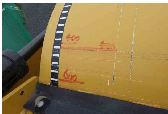
写真-3.17 掘削深度の設定
