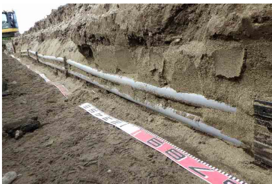
写真-3.40 砂充填性の確認（施工後1年）左：RR-VE管、右：角型FEP管
