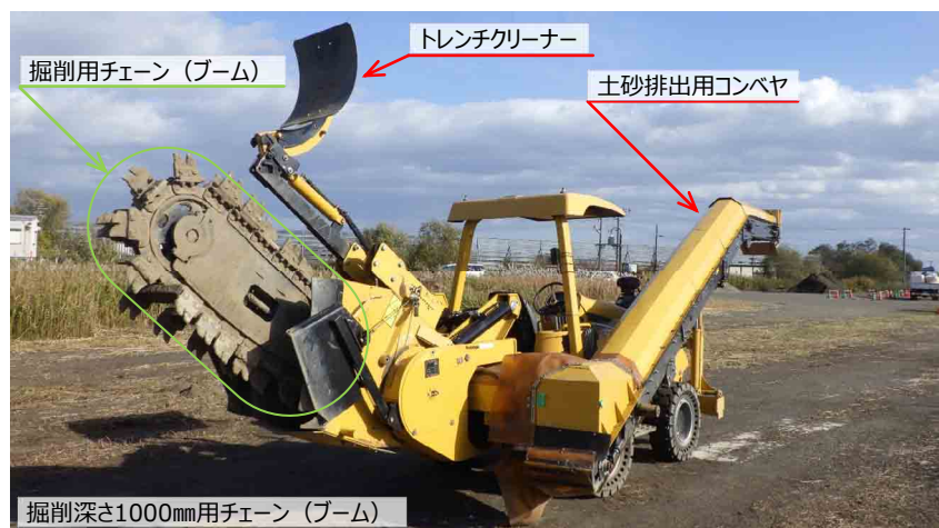
写真-3.1 トレンチャー全景
