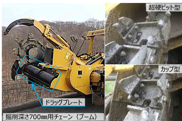
写真-3.2 掘削用チェーン
