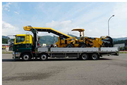
写真-3.11 11tトラックによるトレンチャー運搬
