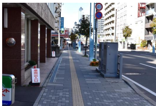
写真-2.16 地上機器が歩道上にあると歩行者は歩きにくさを感じる （左）一般的な地上機器の配置位置（歩車道境界部）（右）歩道が狭いほど、より歩きにくさを感じる
