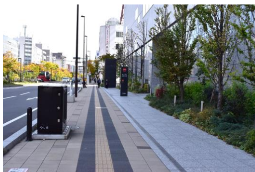
写真-2.16 地上機器が歩道上にあると歩行者は歩きにくさを感じる （左）一般的な地上機器の配置位置（歩車道境界部）（右）歩道が狭いほど、より歩きにくさを感じる
