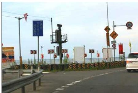
複数の線形誘導標示板とクッションドラムおよび警戒標識等の道路標識が乱立している。あまりに多い情報は、ドライバーに対して混乱を生じる。
