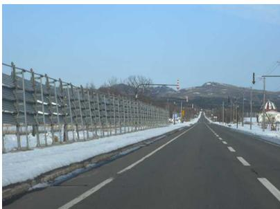
防雪柵と固定式視線誘導柱が重複設置されている事例。（道道52号・弟子屈町）
