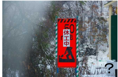
休工中で通行に支障がないにもかかわらず、工事の標識が設置されていると、混乱を招く。
