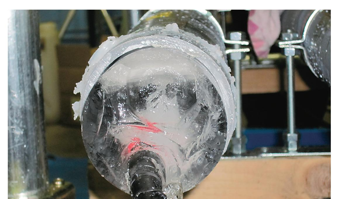
▲寒地土木研究所における管路光ケーブルの凍結隔解実験
