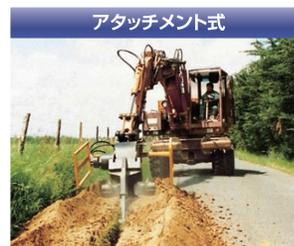
油圧ショベル、トラクタショベル、トラクターなどに装着して使用するもの。
