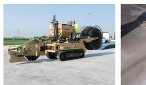
頑固な地盤にも対応。掘削幅が狭く、比較的浅い掘削深さの施工に適している。
