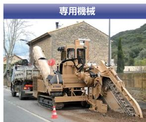
クローラ又は車輪を有する専用車体に作業装置が装着されているもの。
