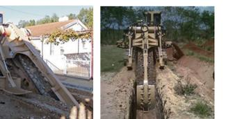
縦長の排土板を有したもの。柔らかい地盤に対応。農地等比較的やわらかい地盤での施工に適している。
