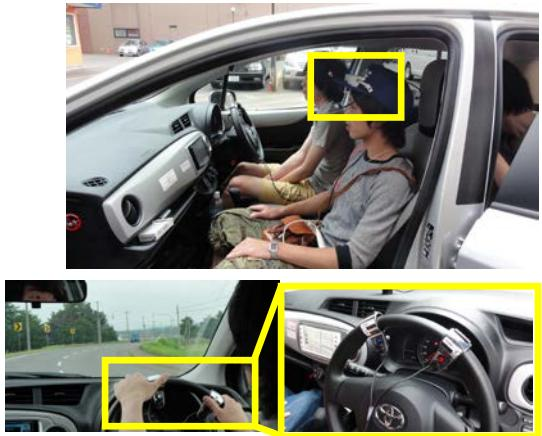
写真-4 走行実験の状況（運転者は印象評価ボタン、助手席はアイマークカメラ+印象評価ボタン）
