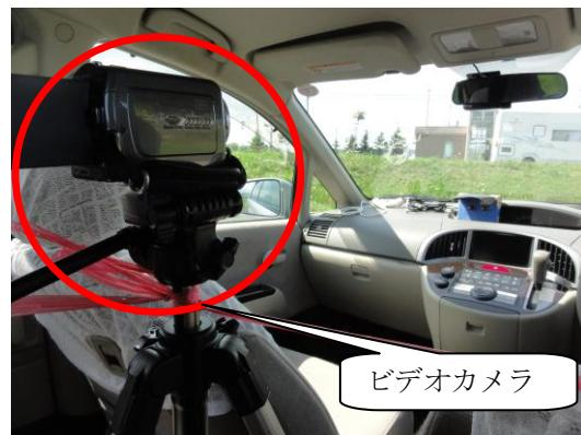
写真-8 実験車内に設置したビデオカメラ
