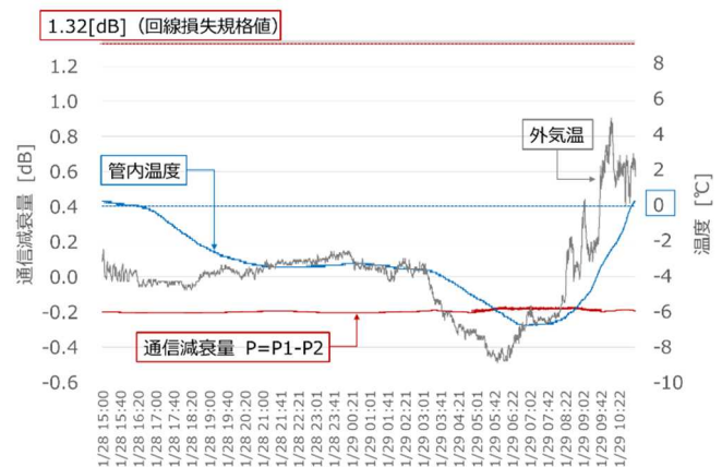
図-3.20 通信減衰量 P の測定結果例（供試体1）
