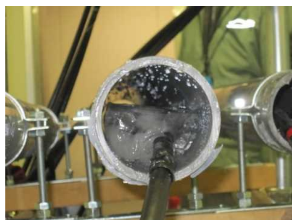
写真-3.6 凍結後の供試体内部 (上：満水 下：半水)
