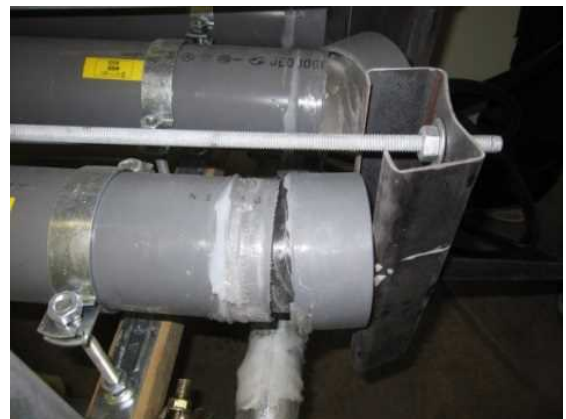
写真-3.5 満水凍結後の供試体蓋部
