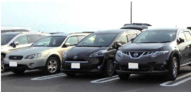
写真-7 車両の大型化によりこれまでの基準では狭くなっている「道の駅」の駐車マス
